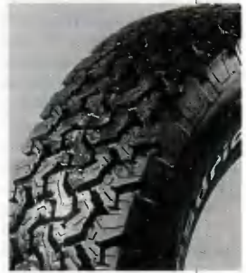
Рельефные рисунки на поверхности шины служат для увеличения трения.
