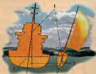
Метацентр корабля должен находиться выше центра тяжести: 1 — метацентр; 2 — центр тяжести; 3 — центр водоизмещения.
